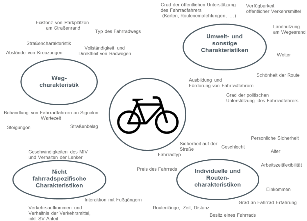
Abbildung 2: Einflüsse auf die Routenwahl des Radfahrers [eigene Darstellung nach Hunt und Abraham, 2007]
